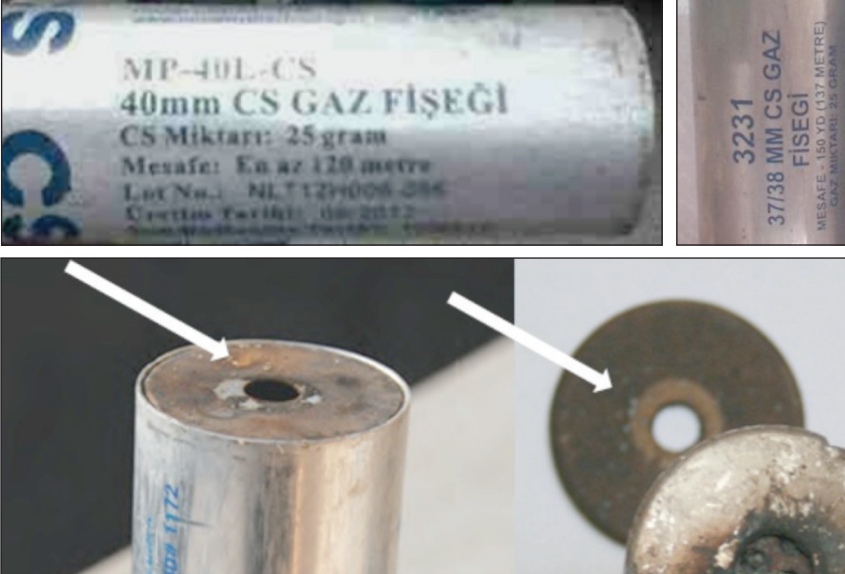
Resim 5-6-7: Gaz fişegi yapısı; ağız yapısının çapı 40 mm, 37 mm, 38 mm olabilmektedir. Ortasında 1 cm çaplı açıklık gaz çıkışının olduğu bölgedir.
